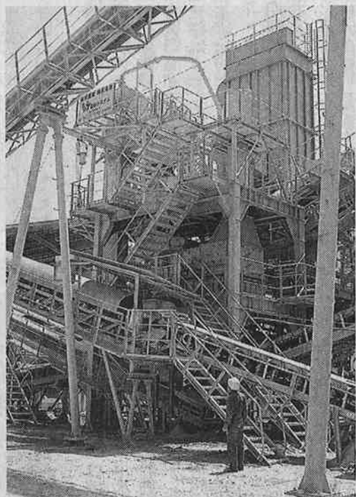
粒のバランスが良い砂を造れる「V7製砂システム」(東広島市の福原産業)
